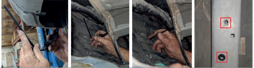
**ШАГ 3.** Сопоставьте отверстия в лонжероне с отверстиями в кронштейнах и зафиксируйте их положение с помощью болтов M10x1,25x40, шайб 10 гроверных и шайб 10. Загните гибкие концы закладных деталей вовнутрь лонжерона.
