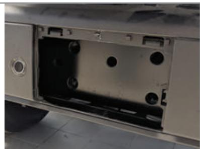
**ШАГ 2.** Для установки балки ТСУ совместите отверстия в балке с выполненными автопроизводителем отверстиями в задней поперечине рамы. Прикрутите ТСУ к задней поперечине рамы с помощью болтов M14x1,5x45, через шайбы 14 и шайбы 14 гроверные.
