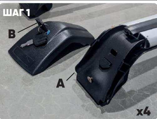
Откройте ключом замок и снимите пластиковую крышку с крепежного механизма поперечины.
