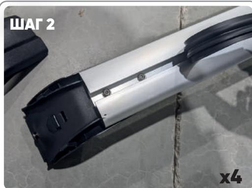
Отогните резиновый уплотнитель и ослабьте с помощью шестигранного ключа два винта в центральном пазу. Ослабьте фиксирующий винт для отвода язычка от опоры крепления. Установите опору на рейлинг с одной стороны автомобиля. Закрутите фиксирующий винт, но не затягивайте его. Повторите процедуру с другой стороны поперечины.
