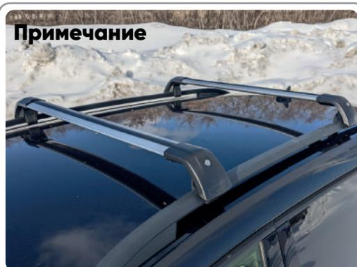
В случае, если поперечина длиннее расстояния между рейлингами, ее следует укоротить и просверлить 2 отверстия в пазу для установки опоры согласно межцентровому расстоянию на отпиленной части поперечины.
