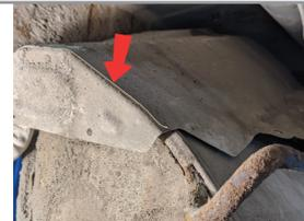
**ШАГ 2.** Установите левый кронштейн крепления, поместив его в отверстие в лонжероне, и совместив штатные шпильки с отверстиями кронштейна.
