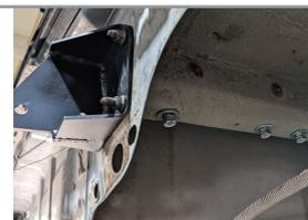
**ШАГ 4.** Установите центральную балку, закрепив её болтами M10 x 30 x1,25 через шайбы 10 и гроверные шайбы 10. Затяните все соединения! Поставьте задний бампер на место, предварительно вырезав в нём отверстие по прилагаемому шаблону.
