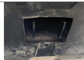
**ШАГ 5.** Установите кронштейн приёмной трубы, закрепив его болтами M12x110x1,25 через шайбы 12, шайбы 12 гроверные с двух сторон и гайки M12 x1,25. Закрепите кронштейн крепления электрической розетки гайкой M10 с шайбой.
