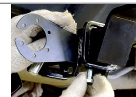
**ШАГ 6.** Установите съёмный шар в сборе и закрепите его пальцем гнутым гальванизированным со шплинтом пружинным игольчатым. Затяните фиксирующий болт M10x20 снизу, он используется для исключения технологических люфтов съёмного шара и только в ненагруженном состоянии! Перед сцепкой болт демонтировать! Установка завершена.
