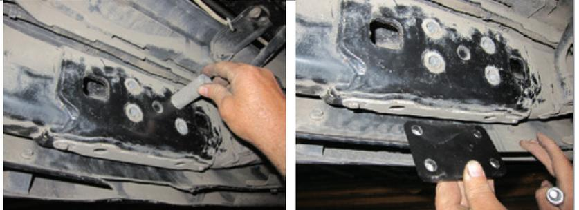
**ШАГ 3.** Установите центральный кронштейн ТСУ вместе с центральной закладной (поз. N), совместив отверстия кронштейна с отверстиями в балке заднего бампера и закрепите всё с помощью четырёх болтов M12x120, через гроверные шайбы 12, шайбы 12 с двух сторон, гайками M12 и двух болтов M16x50 (через шайбы 16 гроверные) и двух болтов M6x35 снизу кронштейна.
