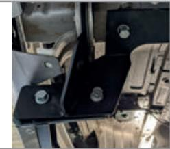
**ШАГ 5.** Установите на место тепловые отражатели, дефлекторы, глушитель на подушки и подключите датчик на штатной балке. Установите запасное колесо на место.
