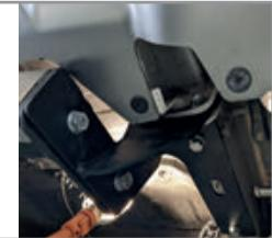
**ШАГ 4.** Наживите балку ТСУ на левый и правый кронштейны. Зафиксируйте положение балки, используя для крепления болты M12, шайбы 12 гроверные и шайбы 12. Затяните все соединения, отрегулировав положение ТСУ.
