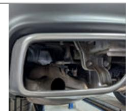
**ШАГ 2.** Установите закладные пластины с двумя гайками в технологические отверстия лонжерона с правой и левой стороны автомобиля. Установите левый кронштейн на 4 шпильки лонжерона.
