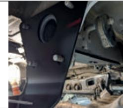
**ШАГ 3.** Установите штатную балку на место, наживив гайки с левой стороны. Отведите балку с правой стороны так, чтобы в зазор между балкой и шпильками прошёл для установки фланец правого кронштейна, установите правый кронштейн, установите штатную балку с правой стороны на место и наживите 4 гайки с правой стороны. Наживите кронштейны и закладные пластины болтами M12, шайбами 12 гроверными и шайбами 12.
