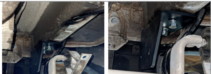
**ШАГ 4.** Установите балку ТСУ на кронштейнах с помощью болтов M10x1,25x40 и гайки M10x1,25, через шайбы 10 и гроверные шайбы 10. Отрегулируйте положение ТСУ и затяните все соединения. Закрепите глушитель обратно на место.
