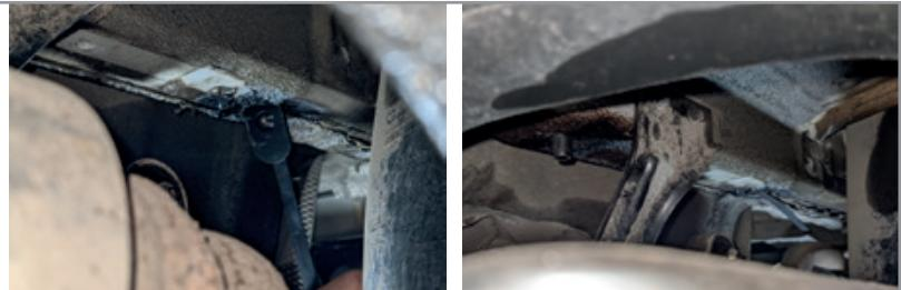
**ШАГ 3.** Закрепите кронштейны левый и правый на шпильке закладной пластины с помощью гайки M12x1,25 через шайбу 12 и гроверную шайбу 12, а также на приварной гайке закладной пластины с помощью болта M10x1,25x35 через шайбу 10 и гроверную шайбу 10.
