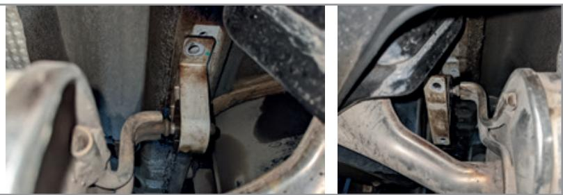
**ШАГ 2.** Поместите закладную пластину внутрь лонжерона, совместив шпильку и приварную гайку с соответствующими отверстиями в лонжероне.
