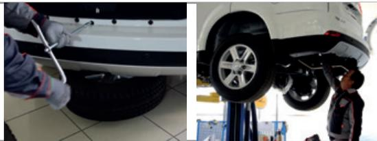
**ШАГ 2.** Выкрутите два штатных болта М12 крепления задней балки, как показано на фото. Установите кронштейн боковой на раму, совместив отверстия в кронштейне с отверстиями крепления задней балки и закрутите его входящими в комплект поставки болтами М12х1,25х45 с юбкой, но не затягивайте.
