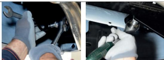
**ШАГ 5.** Установите съемный шар в сборе и закрепите его пальцем гнутым с шплинтом. Зафиксируйте съемный шар винтом М10х20 снизу, он используется для исключения технологических люфтов съемного шара и только в ненагруженном состоянии! Перед сцепкой болт демонтировать!
