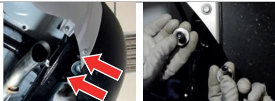
**ШАГ 3.** Для установки балки ТСУ совместите отверстия в кронштейне с отверстиями в боковых кронштейнах и соедините болтами М10х40, гайками М10 через шайбы 10 гроверные и шайбы 10.
