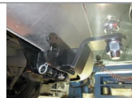
**ШАГ 6.** Установите фиксирующий болт M10x20 снизу, он используется для исключения технологических люфтов съёмного шара и только в ненагруженном состоянии! Перед сцепкой болт демонтировать! Установка завершена!
