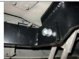
**ШАГ 4.** Для установки угловых кронштейнов, вставьте в технологические отверстия лонжеронов закладные пластины с гайками M12. Установите угловые кронштейны и соедините всё с помощью метизов из комплекта поставки, согласно схемы.
