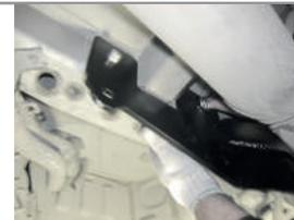
**ШАГ 3.** Установите балку ТСУ, совместив отверстия в балке ТСУ с отверстиями в боковых кронштейнах и соедините всё с помощью болтов M10x1,25x40, гаек M10x1,25, шайб 10 и шайб 10 гроверных.
