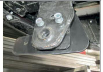
**ШАГ 4.** Установите балку ТСУ, совместив отверстия балки ТСУ с отверстиями боковых кронштейнов и соедините их с помощью болтов М12х1,25х45 через шайбы 12 и шайбы 12 гроверные, гайками М12х1,25. Соединения не затягивать.
