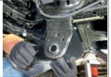
**ШАГ 3.** Закрепите закладную пластину на буксирной проушине с помощью двух болтов М10х1,25х40 через шайбы и шайбы 10 гроверные, как показано на фото.
