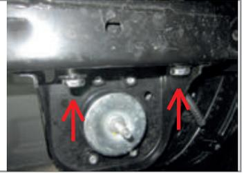
**ШАГ 2.** Установите кронштейн правый и закрепите его двумя болтами М12х1,25х45 с юбкой к штатным закладным гайкам.
