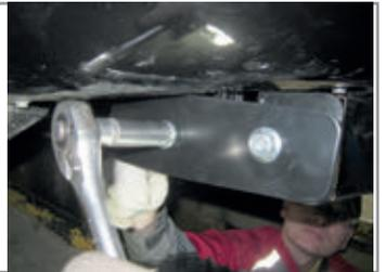
**ШАГ 6.** Установите съемный шар в сборе и закрепите его пальцем гнутым со шплинтом. Зафиксируйте съемный шар болтом М10х20 снизу. Затяните съёмный шар с помощью ключа на 38 мм. Установка завершена.
