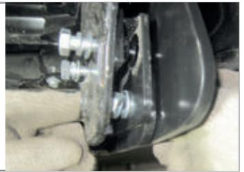
**ШАГ 5.** Отрегулируйте положение фаркопа и затяните все резьбовые соединения.
