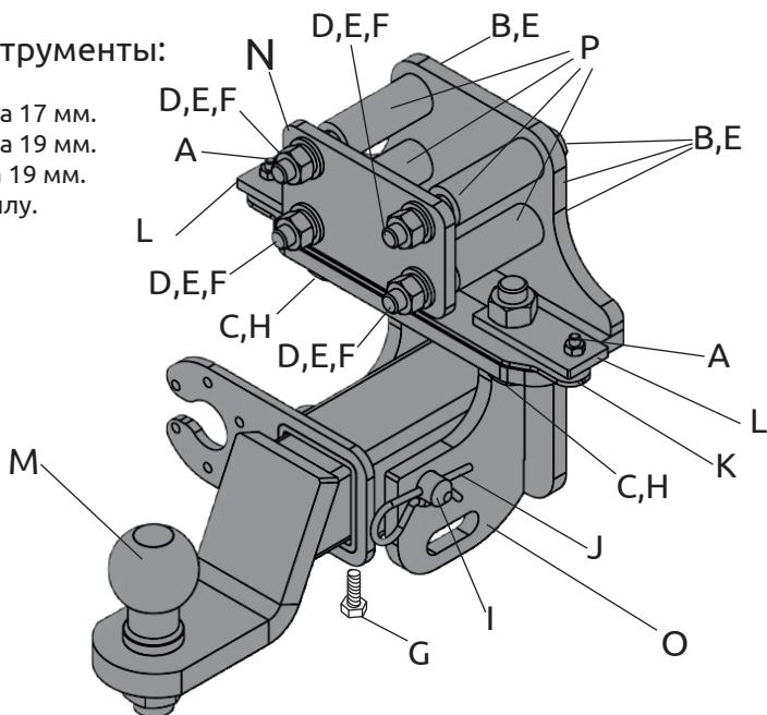
Класс прочности метизов: Болт - 8.8, Гайка - 8
