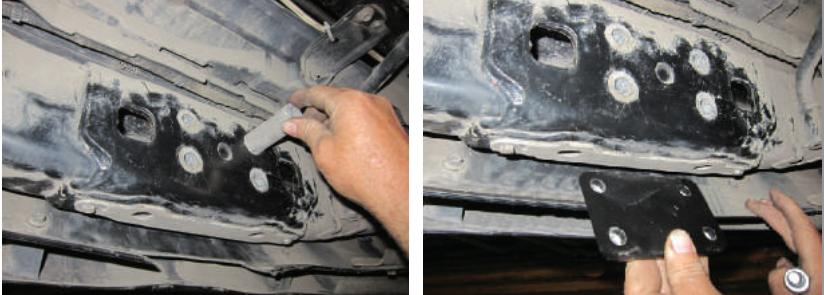
**ШАГ 3.** Установите центральный кронштейн ТСУ вместе с центральной закладной (поз. N), совместив отверстия кронштейна с отверстиями в балке заднего бампера и закрепите всё с помощью четырёх болтов M12x120, через гроверные шайбы 12, шайбы 12 с двух сторон, гайками M12 и двух болтов M16x50 (через шайбы 16 гроверные) и двух болтов M6x35 снизу кронштейна.
