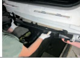
**ШАГ 5.** Затяните все резьбовые соединения. Прикрутите к приставкам усилитель бампера, установите обратно бампер и задние фонари. Закрепите кронштейн розетки гайкой M10 через шайбу и гровер 10.
