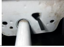
**ШАГ 3.** Установите кронштейн нижний левый, совместив отверстия в кронштейне с отверстиями в лонжероне автомобиля, и, соединив всё при помощи болта M12x40, через шайбу 12 и шайбу 12 гроверную. А так же с помощью болта M10x25, через шайбу 10 и шайбу 10 гроверную. Аналогично установите правый кронштейн и закрепите его с помощью болта M12x40 и шайб 12.
