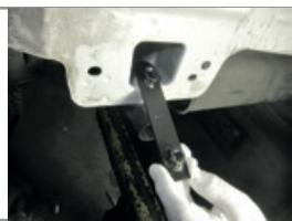
**ШАГ 2.** Установите закладную пластину с одной гайкой в маленькое технологическое отверстие в правой нижней части кузова автомобиля, как показано на фотографии.
