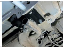
**ШАГ 4.** Установите проставки, левую и правую и закрепите их на кузове автомобиля с помощью болтов M8x25 и M8x40, шайб 8 увеличенных и шайб 8 гроверных.
