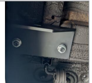
Установите балку ТСУ, соединив её с боковыми кронштейнами с помощью болтов M10x1,25x40, шайб 10, шайб 10 гроверных и гаек M10x1,25. Не затягивайте соединения.
