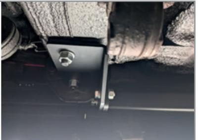
Установите кронштейн розетки при помощи шайбы 10, шайбы 10 гроверной и гайки M10. Установите съёмный шар в сборе и закрепите его пальцем гнутым гальванизированным со шплинтом пружинным игольчатым. Затяните шар ключом на 38 мм. Установите фиксирующий болт M10x20 снизу, он используется для исключения технологических люфтов съёмного шара и только в ненагруженном состоянии! Перед сцепкой болт демонтировать!
