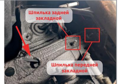
Будучи с левой стороны автомобиля, наживите на шпильку задней закладной металлическую прокладку, после чего зафиксируйте положение прокладки левого кронштейна, наживив его на шпильки закладных с помощью шайб 12, шайб 12 гроверных и гаек M12x1,25. Прделайте те же самые действия с правой стороны автомобиля.
