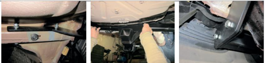
**ШАГ 5.** Установите кронштейн крепления электрической розетки, стопорный винт снизу, **используется для исключения технологических люфтов съёмного шара и только в ненагруженном состоянии! Перед сцепкой болт демонтировать!** Верните глушитель на посадочное место. Закрепите нижнюю часть бампера штатными винтами.
