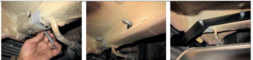
**ШАГ 4.** При необходимости подрежьте бампер с внутренней стороны. Установите балку ТСУ, прикрепив её к кронштейнам с помощью крепежных винтов из комплекта поставки. Установите шар в сборе и затяните его ключом на 38мм.
