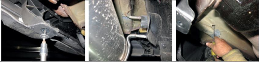
**ШАГ 2.** Удалите пластиковые заглушки с технологических отверстий с каждой стороны задних лонжеронов.
