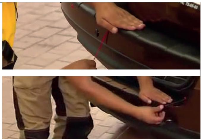
Перед началом эксплуатации накладки необходимо убедиться, что накладка не задевает кромку багажника, для этого закройте полностью багажник. Убедитесь в присутствии равномерного зазора не менее 4-5 мм вдоль всей кромки багажника, в противном случае отрегулируйте крепление крышки багажника добившись необходимого зазора!
