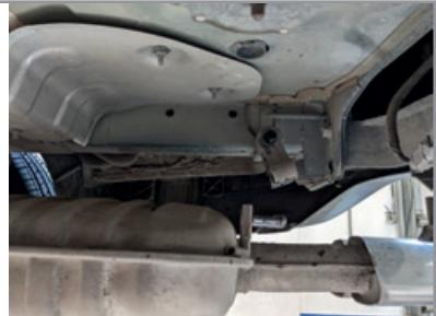
**ШАГ 2.** Установите правый кронштейн, совместив отверстия кронштейна с отверстиями в лонжероне автомобиля, и зафиксируйте его положение с помощью болтов M12x1,25x110, шайб 12, шайб 12 гроверных, гаек M12x1,25, болтов M10x1,25x30, шайб 10 увеличенных и шайб 10 гроверных. Аналогичным образом зафиксируйте положение левого кронштейна.
