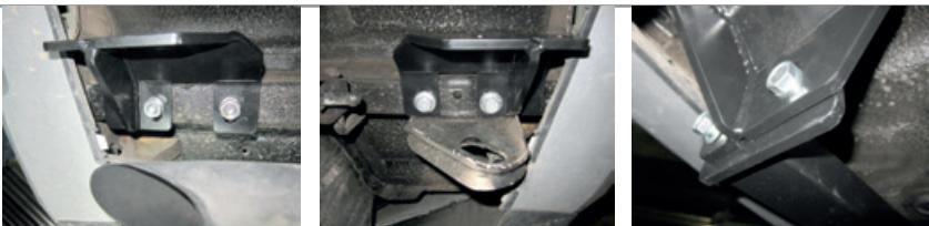
**ШАГ 5.** Установите кронштейн розетки и закрепите его с помощью гаек M10, шайбы 10 и шайбы 10 гроверной. Затяните все соединения, отрегулировав положение ТСУ. Установите съемный шар в сборе и закрепите его пальцем гнутым гальванизированным со шплинтом пружинным игольчатым. Установите обивки на место.
