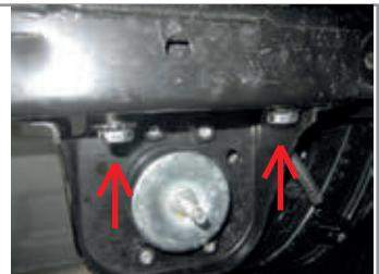
**ШАГ 2.** Установите кронштейн правый и закрепите его двумя болтами M12x1,25x45 с юбкой к штатным закладным гайкам.
