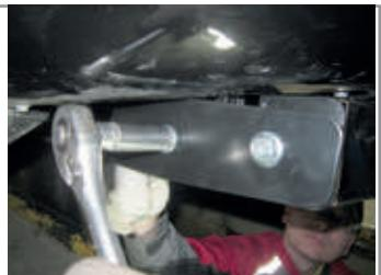
**ШАГ 6.** Установите съемный шар в сборе и закрепите его пальцем гнутым со шплинтом. Зафиксируйте съемный шар болтом M10x20 снизу. Затяните съемный шар с помощью ключа на 38 мм. Установка завершена.
