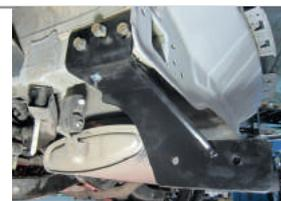
**ШАГ 4.** Установите бампер. Установите балку ТСУ, совместив отверстия балки ТСУ и боковых кронштейнов. Соедините их с помощью болтов М12х1,25х40 гайками М12х1,25 через шайбы 12 с двух сторон.
