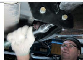
**ШАГ 5.** Установите съёмный шар в сборе и закрепите его пальцем гнутым со шплинтом. Перед установкой фартуков просверлите в них отверстия под шпильки.
