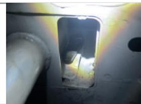
**ШАГ 2.** Аналогичным образом установите закладные шпильки М8 и пластины с левой стороны автомобиля. Убедитесь, что отверстия в закладных пластинах соосны с отверстиями в лонжеронах автомобиля.
