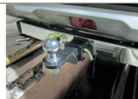
**ШАГ 6.** Затяните шар ключом на 38 мм. Установите фиксирующий болт М10х20 снизу, он используется для исключения технологических люфтов съёмного шара и только в ненагруженном состоянии! Перед сцепкой болт демонтировать!
