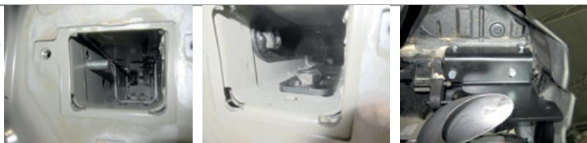
**ШАГ 4.** Установите балку ТСУ, совместив отверстия с отверстиями в боковых кронштейнах и соедините их с помощью болтов M10x40 через шайбы и шайбы 10 гроверные.
