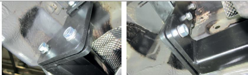
**ШАГ 5.** Установите кронштейн розетки и закрепите его с помощью болта M10, шайбы 10 гроверной и шайбы 10. Затяните все соединения, отрегулировав положение ТСУ. Установите съемный шар в сборе и закрепите его пальцем гнутым гальванизированным со шплинтом пружинным игольчатым. Затяните шар ключом на 38 мм. Установите задний бампер, согласно руководства по ремонту автомобиля.
