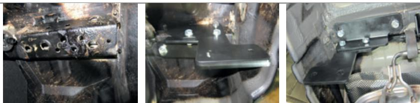
**ШАГ 3.** Установите кронштейн левый, совместив отверстия кронштейна с отверстиями в лонжероне автомобиля и соедините их с закладными пластинами с помощью болтов M10x40 через шайбы 10 и шайбы 10 гроверные.
