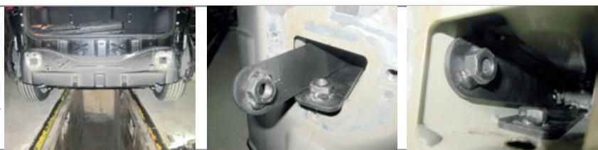
**ШАГ 2.** Установите кронштейн правый, совместив отверстия кронштейна с отверстиями в лонжероне автомобиля и соедините их с закладными пластинами с помощью болтов M10x40 через шайбы и шайбы 10 гроверные. Аналогично установите уголок (поз.1).
