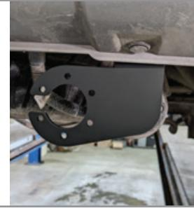
**ШАГ 4.** Установите фиксирующий болт M10x20 снизу, он используется для исключения технологических люфтов съемного шара и только в ненагруженном состоянии! Перед сцепкой болт демонтировать!
