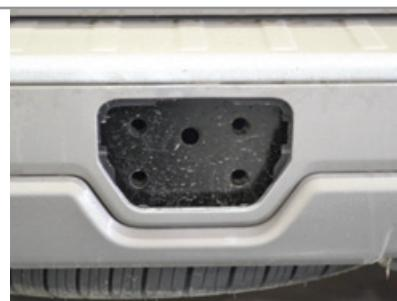
**ШАГ 2.** Для установки балки ТСУ совместите отверстия в балке с выполненными автопроизводителем отверстиями в задней поперечине рамы. Прикрутите ТСУ к задней поперечине рамы с помощью винтов M12x1,25x40 с шестигранным углублением под ключ, через шайбы 12 и шайбы 12 гроверные. Отрегулируйте положение балки ТСУ относительно задней поперечины рамы и затяните все соединения.
