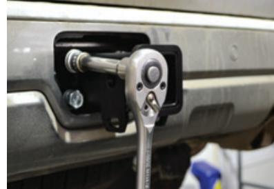
**ШАГ 3.** Демонтируйте штатный болт правого кронштейна крепления бампера. Установите кронштейн розетки и закрепите его штатным болтом кронштейна крепления бампера.
