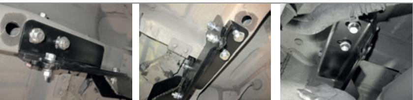
**ШАГ 5.** Затяните все соединения, отрегулировав положение ТСУ. Установите съёмный шар в сборе и закрепите его пальцем гнутым гальванизированным со сплинтом пружинным игольчатым.
