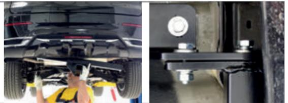
**ШАГ 5.** Затяните все резьбовые соединения. Закрепите кронштейн розетки гайкой М10 через шайбу 10 увеличенную и шайбу 10 гроверную. Установите съёмный шар в сборе и закрепите его пальцем гнутым со шплинтом. Зафиксируйте съёмный шар винтом М10х20 снизу. Затяните шар с помощью ключа рожкового или головки на 38мм.
