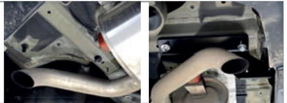
**ШАГ 4.** Для установки балки ТСУ совместите отверстия в балке ТСУ с отверстиями кронштейнов и соедините всё болтами М10х1,25х40 через шайбы 10, гайками М10х1,25.
