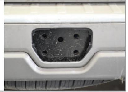
**ШАГ 2.** Для установки балки ТСУ совместите отверстия в балке с выполненными автопроизводителем отверстиями в задней поперечине рамы. Прикрутите ТСУ к задней поперечине рамы с помощью винтов M12x1,25x40 с шестигранным углублением под ключ, через шайбы 12 и шайбы 12 гроверные. Отрегулируйте положение балки ТСУ относительно задней поперечины рамы и затяните все соединения.
