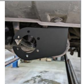
**ШАГ 4.** Установите фиксирующий болт M10x20 снизу, он используется для исключения технологических люфтов съёмного шара и только в ненагруженном состоянии! Перед сцепкой болт демонтировать! Установка завершена.
