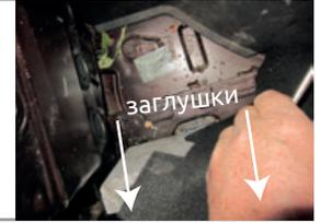
ШАГ 2. С помощью плоской отвертки найдите скрытые в лонжероне технологические отверстия. Проденьте болты М10х90 с надетыми на них шайбами 10 увеличенными и втулками в отверстия через багажник автомобиля. Демонтируйте заглушку, указанную на фото. В отверстие поместите закладную шпильку М10х40.
