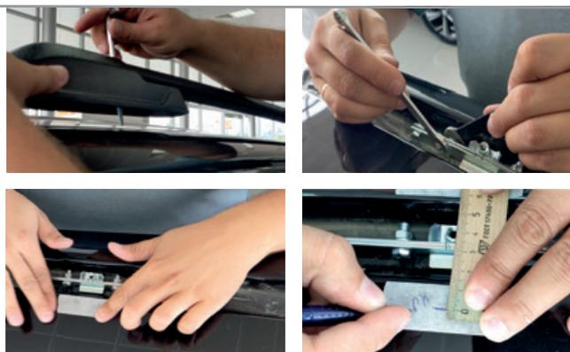
**ШАГ 3.** Приложите накладку жёлоба на место. Отметьте на накладке положение гаек, согласно ранее нанесенной разметке. Просверлите отверстия в накладке.
