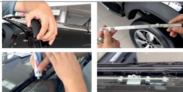
**ШАГ 2.** Наживите рейлинг на кронштейны, чтобы отрегулировать положение кронштейнов при помощи винтов М6х50 спереди и сзади. Винты должны закручиваться свободно и без перекосов, в противном случае положение кронштейна надо скорректировать вдоль крыши. Затем снимите рейлинг и затяните крепления кронштейнов с помощью ключа S10. Наклейте кусочки скотча и нанесите разметку соосно гайкам. Измерьте так же расстояние от внутреннего края жёлоба до гайки и запишите.
