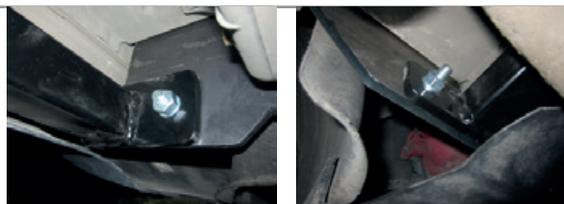
**ШАГ 4.** Установите кронштейн розетки и закрепите его на шпильке с помощью гайки М10 через шайбу 10 увеличенную и шайбу 10 гроверную. Установите съемный шар в сборе и закрепите его пальцем гнутым со шплинтом. Затяните шар ключом на 38 мм.
