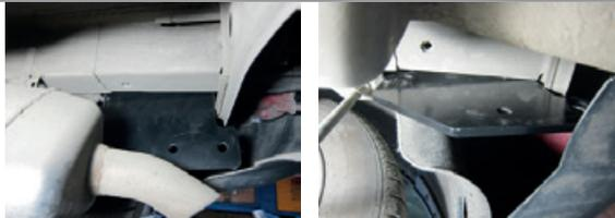
**ШАГ 3.** Установите балку ТСУ, совместив отверстия в кронштейнах боковых и балке ТСУ. Закрепите кронштейн с помощью болтов М10х1,25х40, гайками М10х1,25 через шайбы 10 и шайбы 10 гроверные. Отрегулируйте положение балки ТСУ относительно бампера и затяните все соединения.
