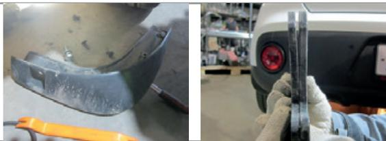
**ШАГ 2.** Для установки кронштейна бокового, отыщите два отверстия с закладными гайками в заднем лонжероне автомобиля. Прикрутите кронштейн к внешней, боковой стороне лонжерона с помощью болтов М10х1,25х40, через шайбы 10 и шайбы 10 гроверные. На другой стороне автомобиля кронштейн боковой устанавливается аналогично. Соединения не затягивайте.
