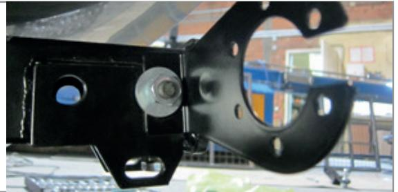
**ШАГ 5.** Установите фиксирующий болт M10x20 снизу, **он используется для исключения технологических люфтов съемного шара и только в ненагруженном состоянии!** Перед сцепкой болт демонтировать!
