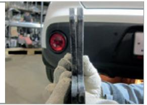
**ШАГ 2.** Для установки кронштейна бокового, отыщите два отверстия с закладными гайками в заднем лонжероне автомобиля. Прикрутите кронштейн к внешней, боковой стороне лонжерона с помощью болтов M10x1,25x40, через шайбы 10 и шайбы 10 гроверные. На другой стороне автомобиля кронштейн боковой устанавливается аналогично. Соединения не затягивайте
