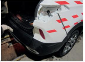
**ШАГ 4.** Установите кронштейн розетки и закрепите его на шпильке с помощью гайки M10 через шайбу 10 увеличенную и шайбу 10 гроверную. Закрепите балку ТСУ на боковых с помощью болтов M12x1,25x40 через шайбы с помощью гаек.
