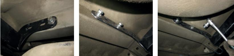
**ШАГ 5.** Установите кронштейн крепления электрической розетки.
