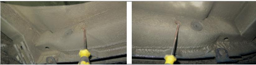
**ШАГ 3.** Для установки фаркопа совместите отверстия в балке ТСУ с резьбовыми отверстиями кузова автомобиля и соедините всё с помощью болтов М10, через шайбы 10 увеличенные и шайбы 10 гроверные.
