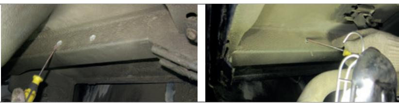
**ШАГ 2.** Отыщите два резьбовых отверстия в задней балке автомобиля, при необходимости прочистите отверстия от грязи.
