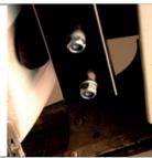
**ШАГ 2.** Для установки центрального кронштейна совместите отверстия кронштейна с отверстиями в ушках поперечной балки и соедините болтами M12x1,25x45 через шайбы 12 и самоконтрящиеся гайки M12x1,25.
